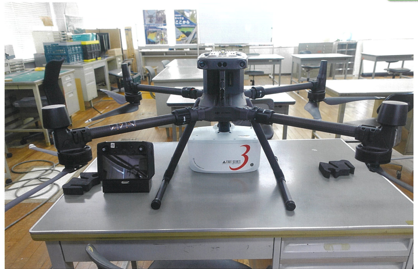
測量で使用するドローンとレーザーセンサー
